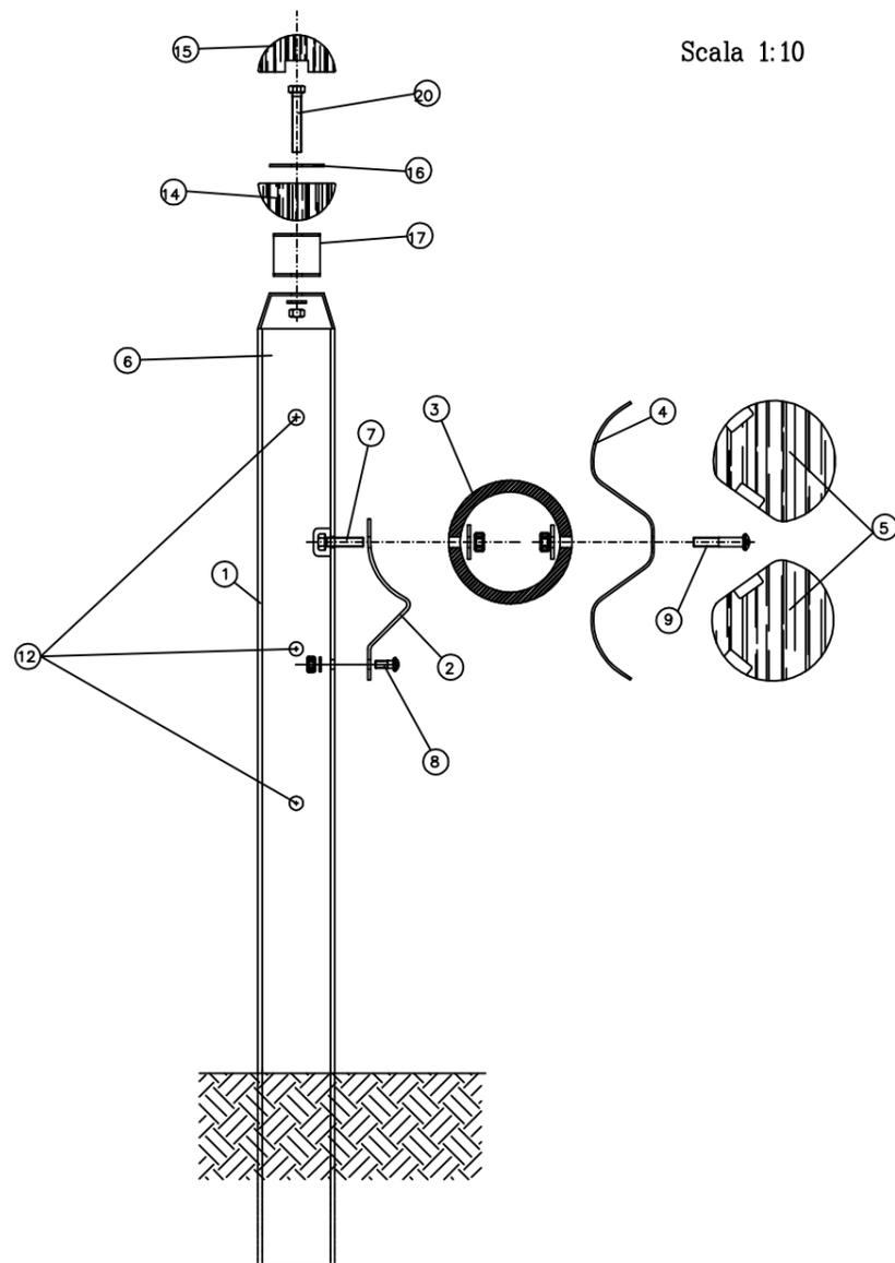
SCHEMA DEGLI ELEMENTI CHE COMPONGONO LA BARRIERA Scala 1:20
